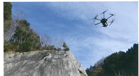
写真-2 ドローンによる熱赤外線撮影状況
