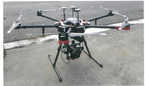
写真-1 熱赤外線カメラを搭載したドローン (DJI社製: MATRICE600)
