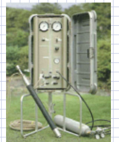
孔内水平載荷試験
