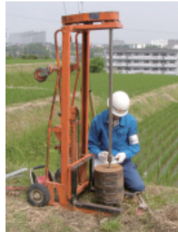
スウェーデン式サウンディング試験(例)
