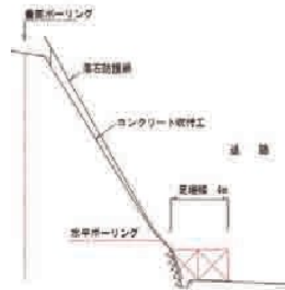
図-1 垂直・水平ボーリング(一般例)
