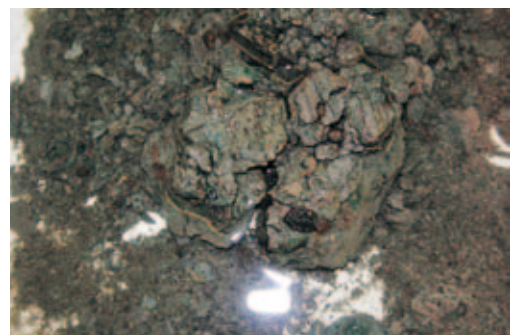
写真:スレーキング試験後の変質角礫凝灰岩
