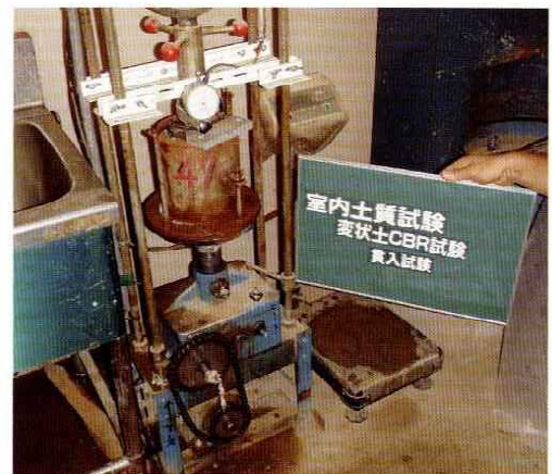
写真-1 CBR試験状況
