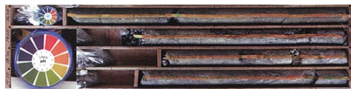
写真.3 強変質帯のボーリングコアで簡易な酸性化可能性試験を実施した例、pHは3~1付近を示す。
