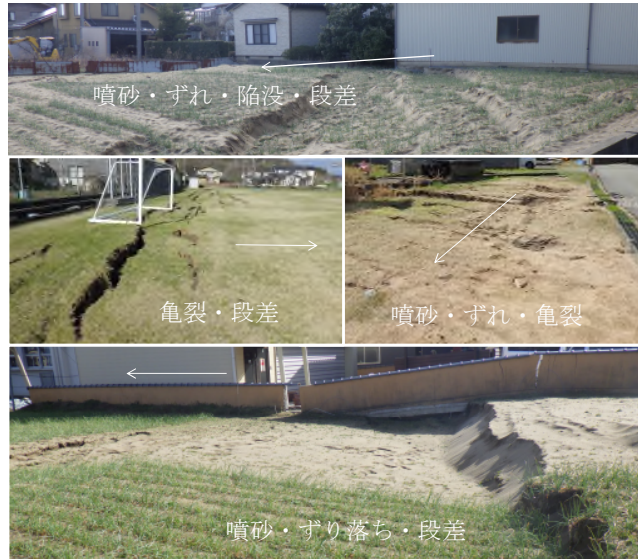
地盤流動による局所的な変状例：矢印は概略の傾斜方向
