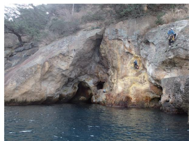
写真-1: ロープアクセスによる岩盤調査
