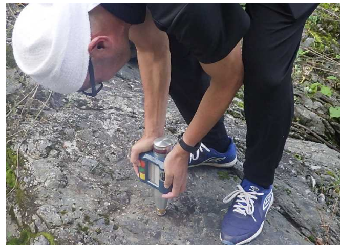
ロックシュミットハンマー試験 ノジュール : 平均反発値 X(R) = 58 (-90^\circ) 推定 q_u = 169.5 \text{ Mpa}
