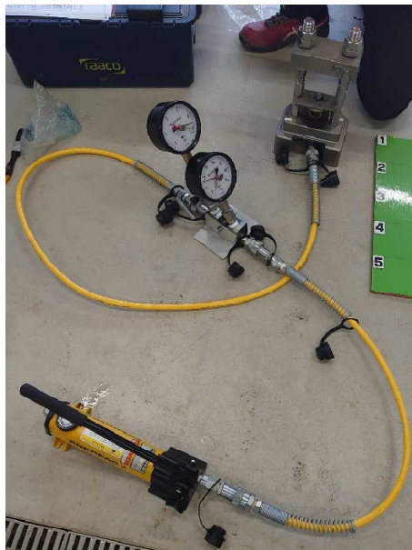
点载荷試験 ノジュール : I_s = 5.21 \text{ Mpa} 推定 q_u = 108.9 \text{ Mpa}
