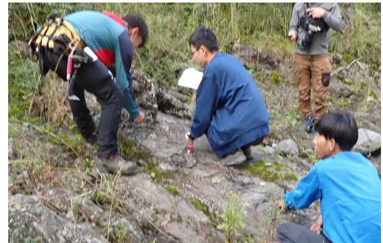
簡易弾性波試験 (* 千頭メランジュ層) V_p = 2.4 (\text{km/s})
