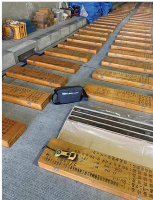
ボーリングBS-3-2 (オールコア) (パイプ歪み計設置・観測)
