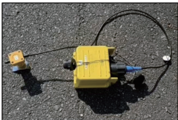
写真-1 微動アレイ探査用データロガー(応用地質(株)製:McSEIS-AT)
