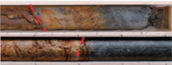
写真3-1 すべり面コア(上段:左側部 下段:右側部)
