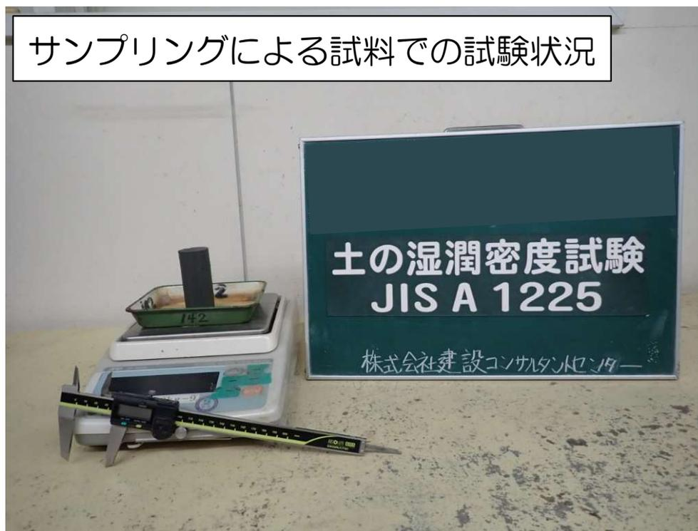
サンプリングで採取された試料をライナーから抜き出し、一定の寸法に整形し、ノギスにて直径、高さを測定する。
