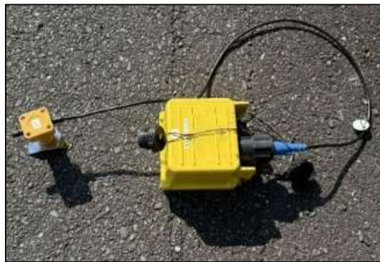
微動アレイ探査用データロガー (応用地質(株)製: McSEIS-AT)
